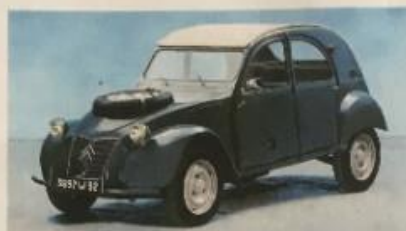
Ein zweiter Motor samt Getriebe macht die Sahara-Version zur gesuchten Offroad-Ente
